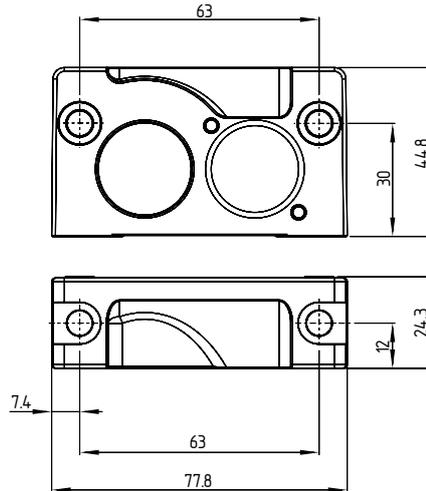
Placa de montagem, parte integrante do conjunto de montagem MS-AZM400 (disponível como acessórios)
