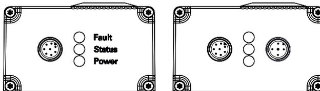
A saída de diagnóstico OUT ou OUT1 ou OUT2 da variante ST2 à prova de curto-circuito, pode ser utilizada para indicação centralizada ou funções de controlo, p. ex., num PLC. Ela reproduz o estado de comutação conforme a tabela 1.
