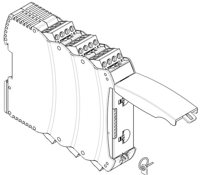
Ajuste da aplicação com o interruptor rotativo "mode"
