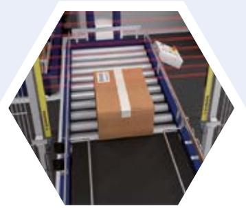
A excepción del primer haz de luz infrarroja (el haz que está más cerca del conector del dispositivo) se pueden utilizar todos los haces para el blanking.
