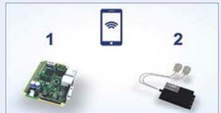
Envío de mediciones, datos de posición, informes de fallas y otros datos útiles del levantamiento para la nube, requiere de algún equipo técnico. Al lado de nuestro controlador, que recopila todas las mediciones y datos, es necesario un gateway para convertir las informaciones en valores comprensibles de la nube. Una segunda función muy importante del gateway es conectar el controlador a Internet con una conexión segura.
