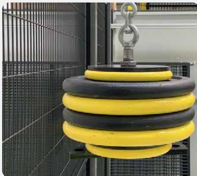
Altura de caída de la masa sobre el suelo (baricentro de la masa): **h0 = 3060 m**
