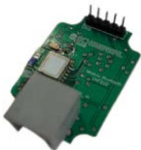
A través de una pequeña placa instalada en la parte superior de la cabina vinculada, la liberación de software es realizada vía D&T en el Cuadro de Mando.
